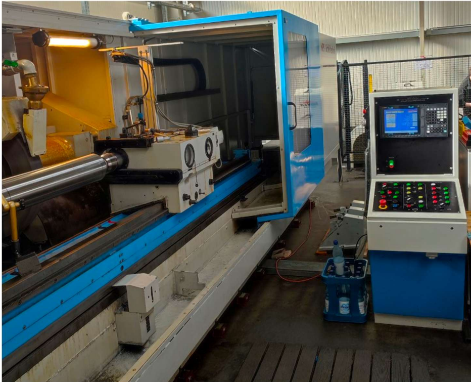
Bild 1: Die Außenrundscheifmaschine der Schleiftechnik Witt mit der M80 CNC-Steuerung von Mitsubishi Electric
